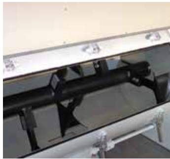
Kammerauskleidung aus Teflon®
