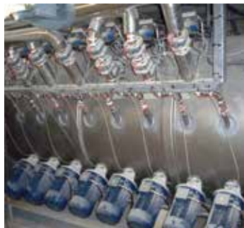
Messerköpfe, Flüssigkeitszugabe, Doppelmantel
